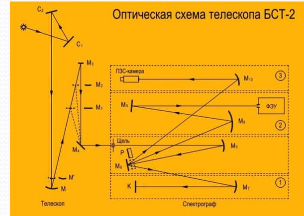
Оптическая схема телескопа БСТ-2
