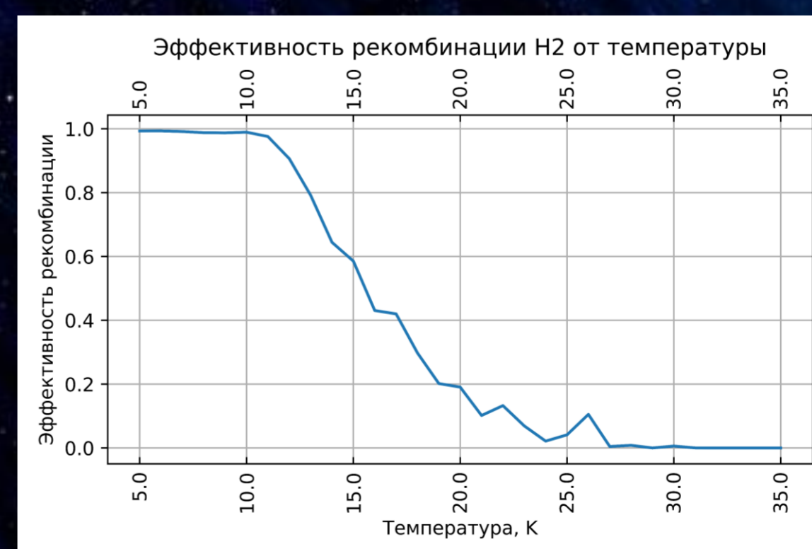
Рисунок 5. Эффективность рекомбинации водорода в зависимости от температуры.
