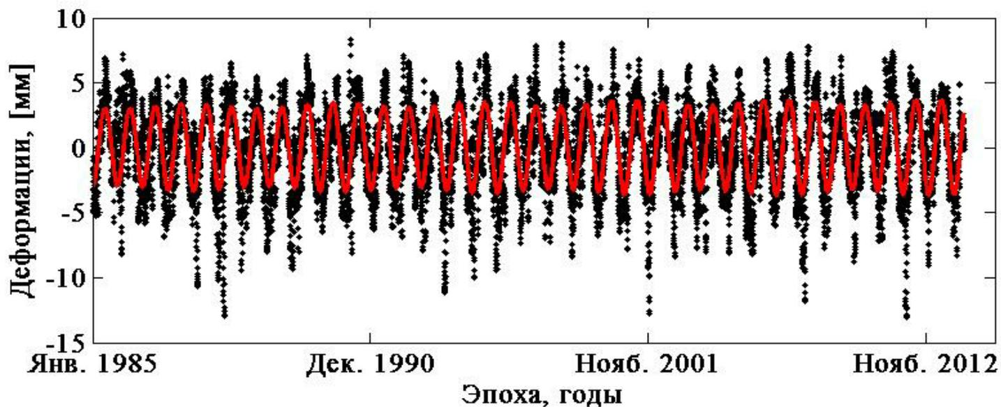
Данные о несмоделированных вертикальных деформациях поверхности земли РСДБ-станции «Симеиз» после удаления ненормированного «белого шума» и тренда (звездочки\*); кривая приближения сезонной составляющей с периодом 365.3 суток и амплитудой равной 3.36 мм (красная, сплошная линия).
