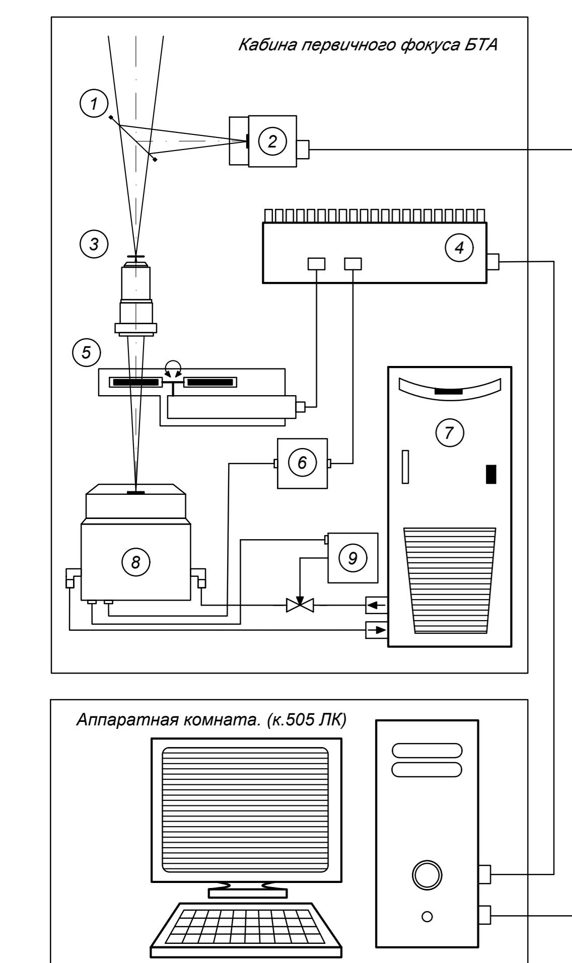
Рис. 1: Структура комплекса наблюдений методом спектр-интерферометрии в ближнем инфракрасном диапазоне: 1 – мембранный светофильтр 92:8, 2 – камера гидрования, 3 – микролинзы 10 $\times$ , 4 – индустриальный компьютер, 5 – моторизированная турель фильтров, 6 – плата видеозахвата (frame grabber), 7 – водяной охладитель, 8 – регистрирующая InGaAs камера, 9 – датчик потока воды в системе охлаждения
